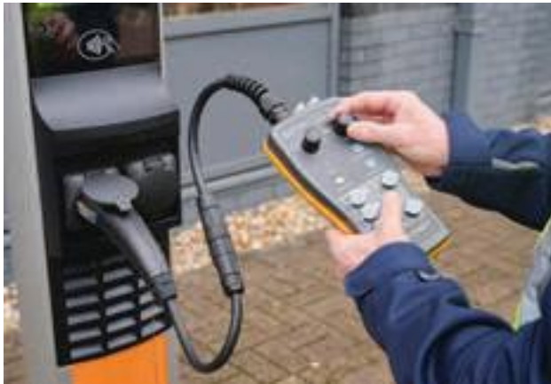
Fluke FEV300, rutin EV şarj testi ve uygunluk kontrollerini verimli bir şekilde gerçekleştirmek üzere tasarlanmıştır.
