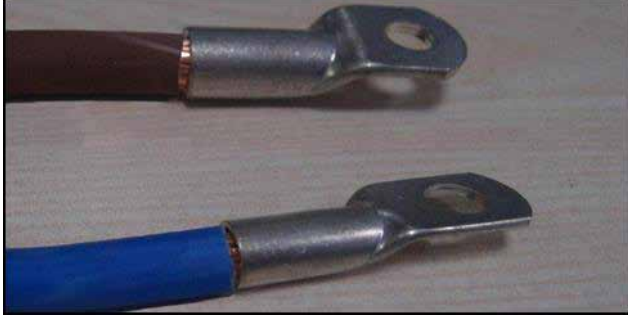
Resim 4: Direkt olarak kablo ucuna bağlanmış ve doğru montaj yapılmış bir pabuç tipi.
